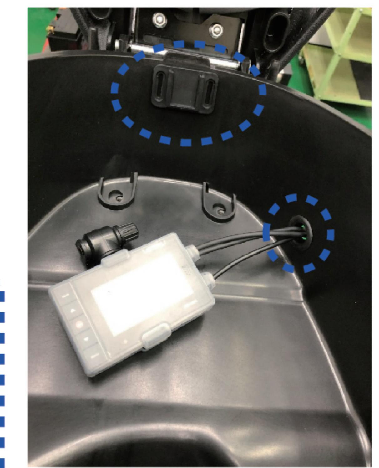
▼Step3. 連接DVR與線路接頭，測試電源，DVR運作正常。
