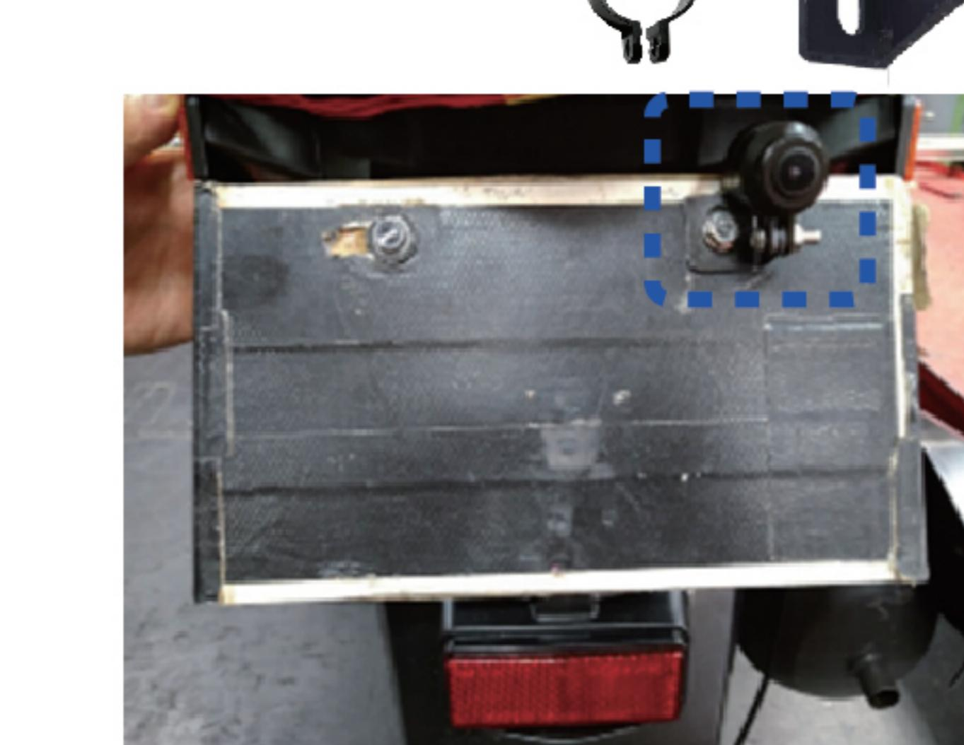
▼將DVR線路，穿過牌照螺孔後方，往主機方向收束線路於車殼內部(使用束帶)。
