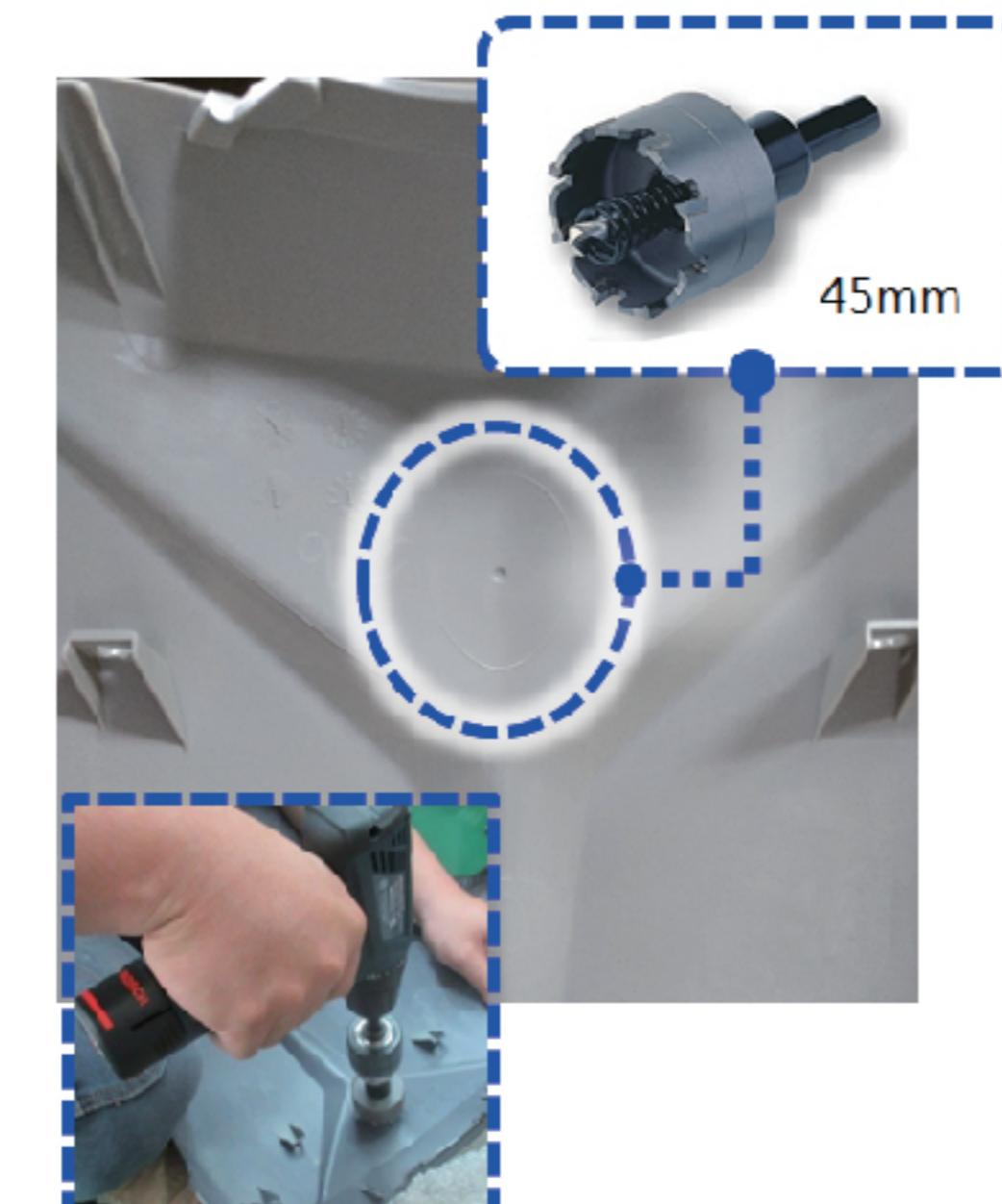
▲Step1. 使用45mm圓穴鋸，運用前面版背後定位點，定位並鑽孔。
