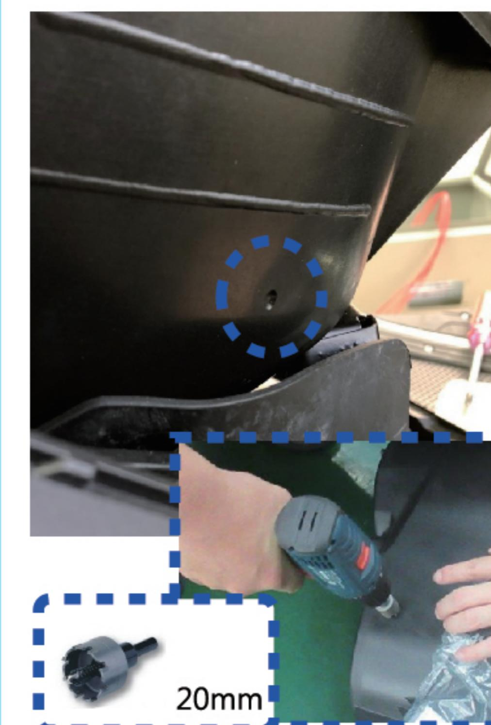
▼Step2. 安裝車廂膠塞，貼上主機支架(並使用攻牙螺絲固定)，安裝主機防水套。
